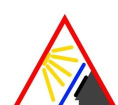
**Le bâchage complet des PPV** limite voire stoppe la production électrique mais l'installation reste sous tension jusqu'à l'onduleur.
